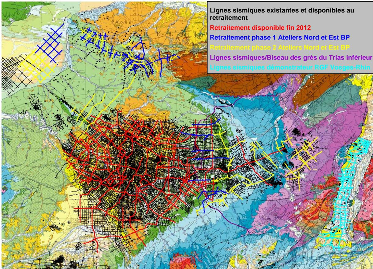
4000 km de **lignes sismiques** retraitées en profondeur en 2012, à interpréter et injecter dans un modèle 3D, via mise en cohérence avec plus de 700 forages le long des lignes. Autres lignes sismiques disponibles, à retraiter (**préciser combien de km ?**)
